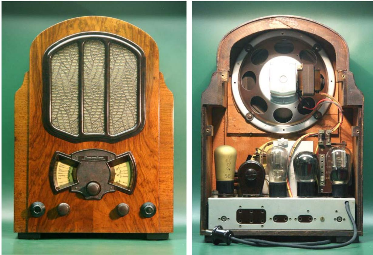
Bild 20: Der restaurierte Empfänger, Ansicht von vorne und bei abgenommener Rückwand.
