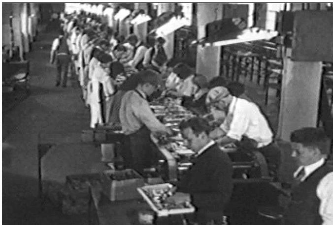
Bild 2: Bandfertigung von Empfängern
