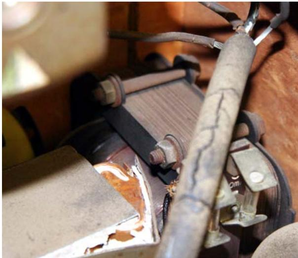
Bild 16: Zerstörter Kondensatorblock
