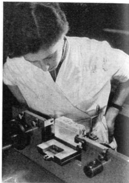
Bild 15: Einfadensäge. Mit einem waagerechten Schnitt wird soeben eine Deckscheibe vom Zuchtblock abgenommen, die später zu Riegeln zugeschnitten wird
