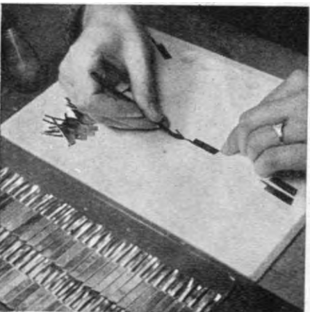
Bild 14: Trapezförmige Platten für Tonabnehmer-elemente werden mit Folie belegt
