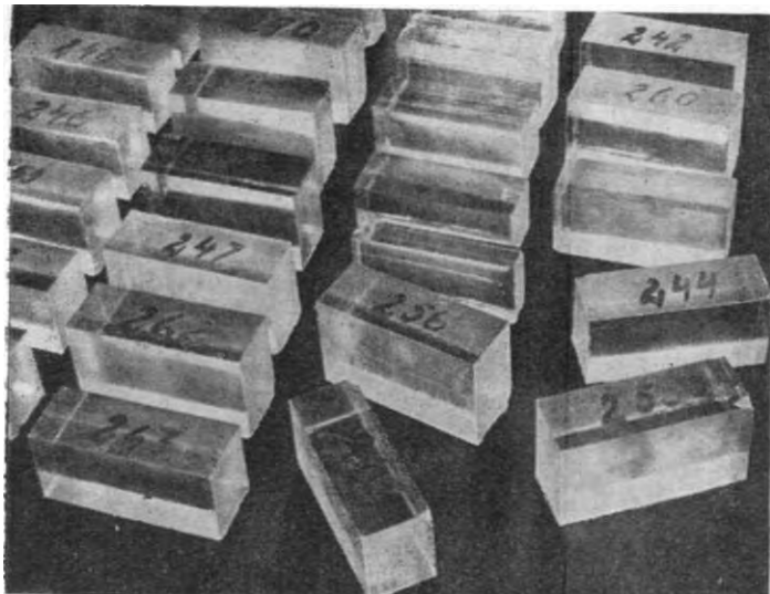
Bild 1: Zuchtblöcke, die auf einem plattenförmigen Keim in einer Zuchtkammer gewachsen sind. Das Gewicht eines solchen Zuchtblockes beträgt etwa 750 g
