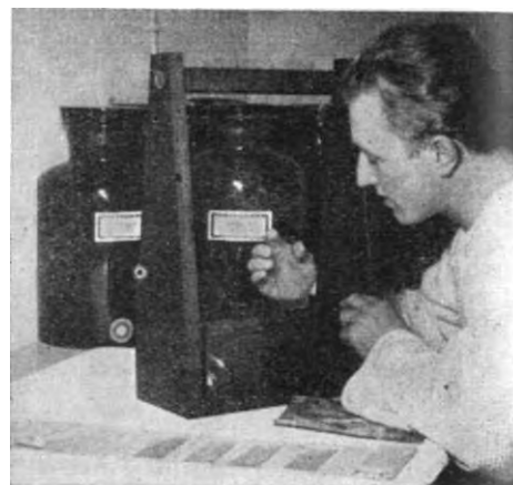
Bild 7: Die Keimplatten werden in die Zuchtkammern der Einsatzgestelle eingepaßt |
