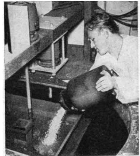
Bild 12: Durch mehrmaliges Filtern erhält man eine vollkommen klare Zuchtlösung. Das nächstfeinere Filter wird eingesetzt
