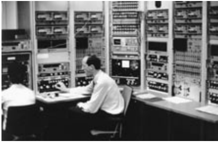
Bild 6: FmAufklGerSatz UHF III in der grenznahen Aufklärungsstelle „Hoher Meißner“. Links oberhalb der Tischplatte die Empfänger RS-111, darüber ein Antennensteuerggerät für die Kreisgruppe, in der Mitte das Kanalschaltfeld, Spektrumanalysator SD 330 und Bandaufzeichnungsgerät, rechts und links je ein TF-Demodulator TFD-1000 mit Kanalbelegungsanzeige, oben diverse Kassettenbandgeräte C 3/20.
