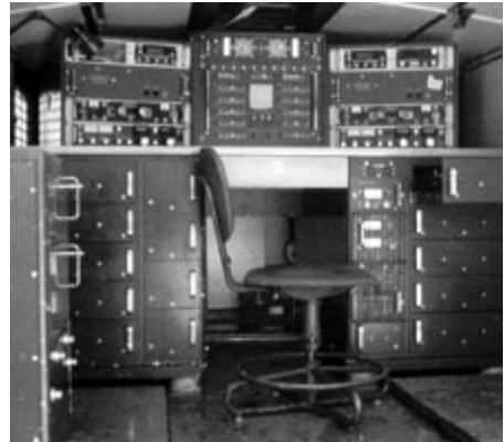
Bild 1: Erfassungsfahrzeug FmAufklGerSatz UHF I (1. Serienversion): Oberhalb der Tischplatte links und rechts die vier CEI-Empfänger, die Panoramaanzeigen dazu, sowie die TF-Demodulatoren. In der Mitte das Bedienfeld und darüber die Antennensteuergeräte. Unter der Tischplatte die Auszüge mit den Tonbandgeräten M 36 und dem Vorrat an Tonbändern.
