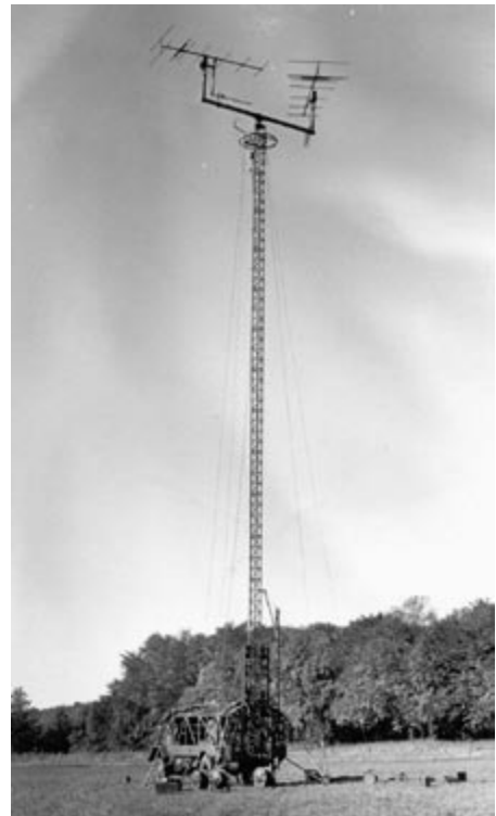
Bild 3: Antennentrupp UHF I (1. Serienversion, mit Antennenträger 40 m, hier 25 m hoch und am Fahrzeug abgespannt).
