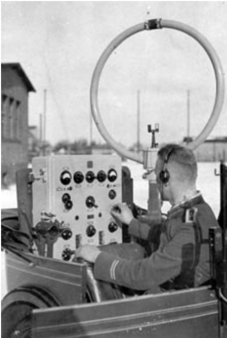
Bild 8: Militärische Peilanlage, eingebaut im PKW Dixi, etwa Mitte der 20er Jahre.
