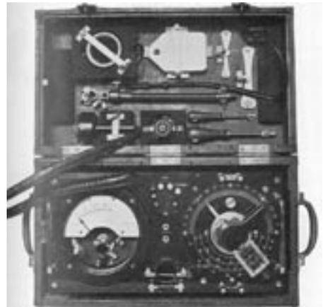
**Bild 15:** *Praktische Ausführung eines Wellenmessers späterer Jahre. Rechts der Drehkondensator mit Eichmarken für drei Kopplungsspulen (Frequenzbereiche), aus [10] beziehungsweise [8].*
