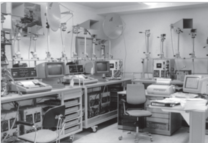
Bild 10 a und b: Zwei Ansichten des Lehrsaals für Elo-Aufklärung in der Fernmeldeschule: Links die „Simulator-Seite“ mit Antekna-Simulator (Steuerung links)
