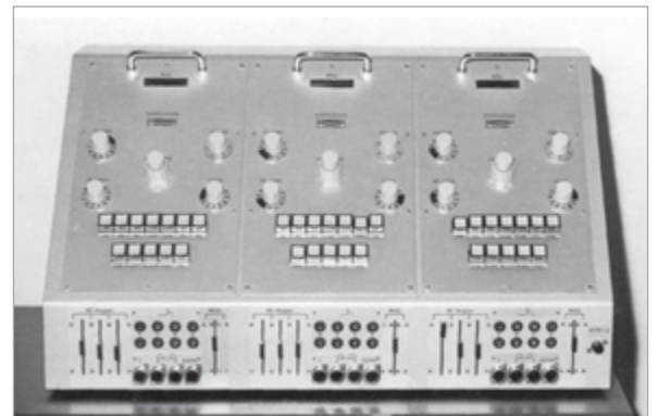
Bild 6: Ausbilderpult der „Ausbildungsausstattung Horchfunker“ Modell 1151 der Firma C. Plath zur Simulation von drei Funksendern im Tastfunk-, Sprechfunk- und Schreibfunkbetrieb.
