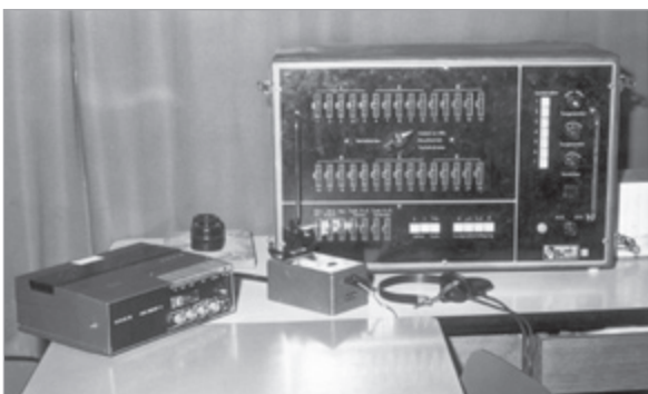
Bild 1: Tastfunkübungsanlage 30 Teilnehmer der Firma Ristow, links ein Standard-Tonbandgerät 4000 report der Firma Uher.
