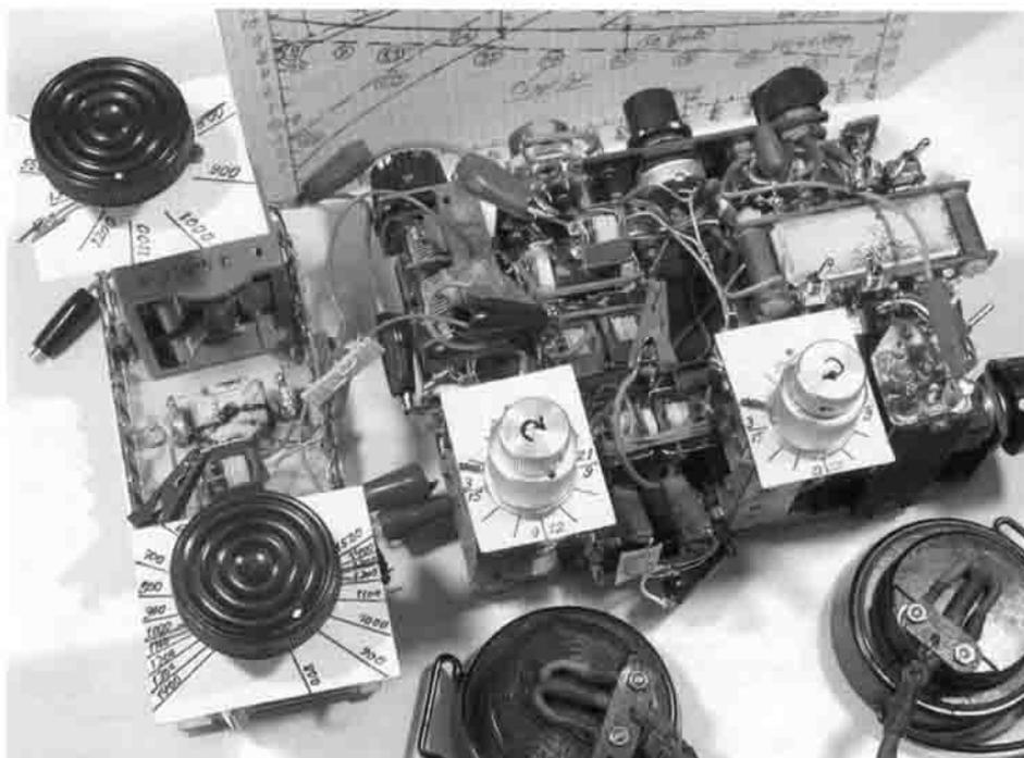
Bild 6: Ansicht des Empfängers mit Platine für den zusätzlichen dritten Schwingkreis
