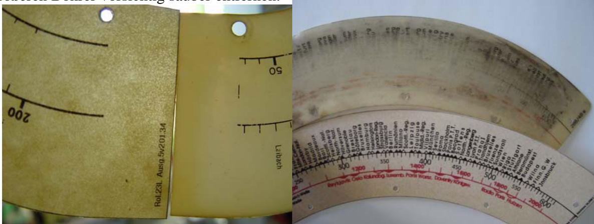
Das **Bild 5** zeigt einen Vergleich der Originalskala und der Nachgebauten Skalenscheibe im Durchlicht, wobei man die körnige, fleckigere Beschaffenheit der Papierskala erkennen kann. Links ist der Nachbau, rechts die Original Skalenscheibe.
