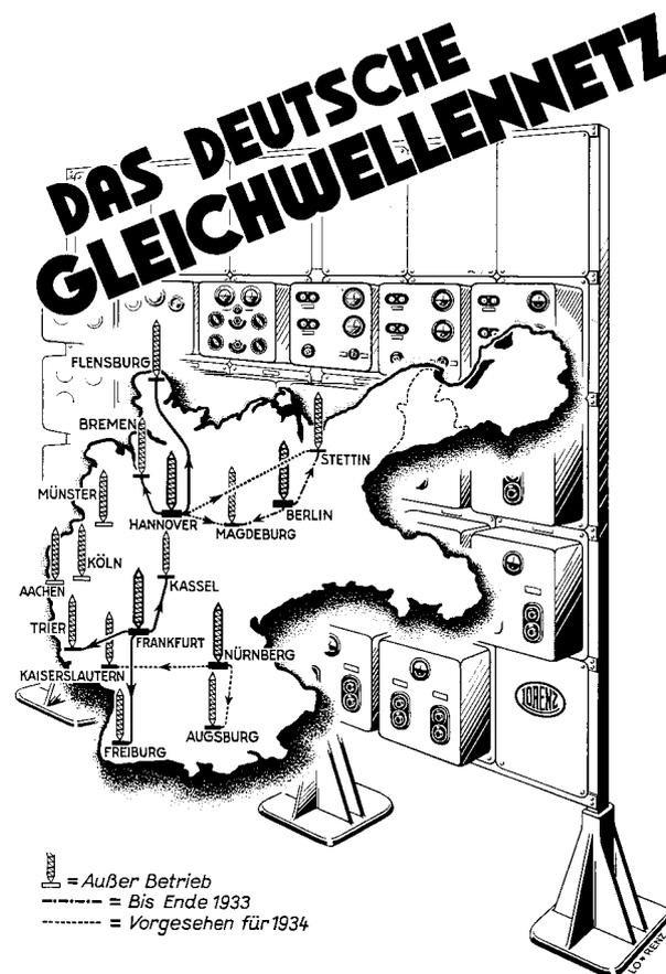
Bild 4.1: Das Gleichwellen-Netz für Mittelwelle 1932–33. Hinter der damaligen Karte von Deutschland ist das Gestell für die Frequenz-Vervielfachung zu erkennen.
