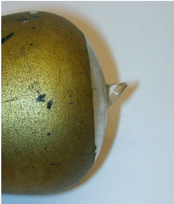
Bild 1: Röhre mit abgerissener Anodenzuleitung
