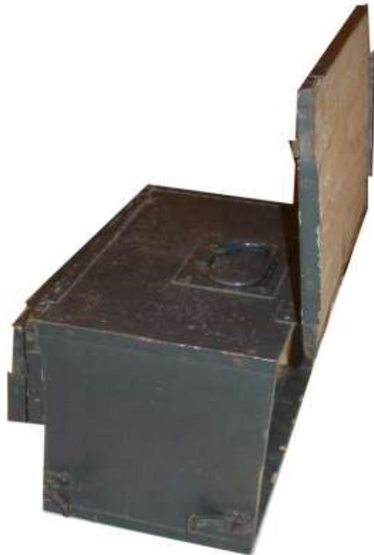
Das leere Gehäuse sieht aus, wie man ein Gehäuse dieser Art erwartet. Daran ist nichts von einfacher Bauart. Auf der Innenseite des Deckels hat wohl einmal die Bedienungsanleitung geklebt. Schade, daß sie heute fehlt. Sie hätte uns sicher geholfen. Leider paßt der vorhandene Empfänger nicht in das bessere Gehäuse hinein. Der Spannungswahlschalter ist um etwa 1 cm zu hoch. Anscheinend hat es im Laufe der Fertigung konstruktive Änderungen gegeben.
