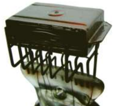
Bild 2: Anodenblech mit Pillenmulde
