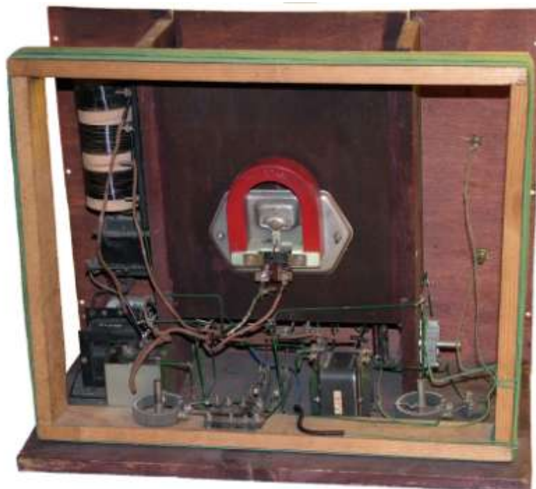
Innenansicht bei abgenommener Lautsprechermembran
