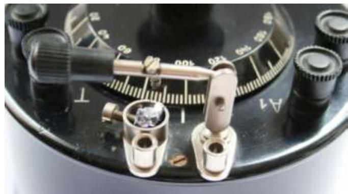
INGELEN Dose, Montierung für Aufsteckdetektor
