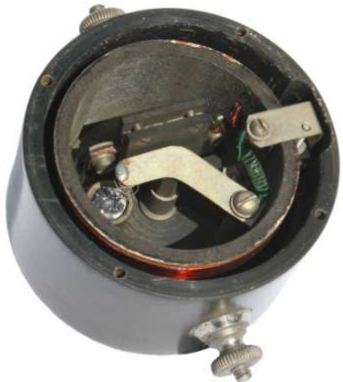
ERICSSON, Miniatur-Detektorapparat, Innenansicht
