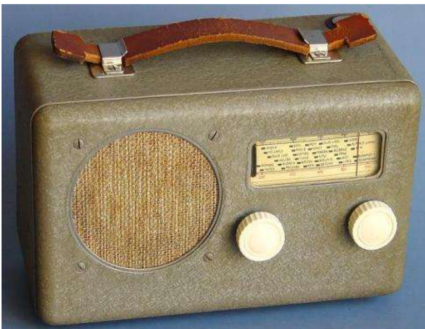
Portable-Gerät aus der Sammlung Heigl 6 Röhren incl. DM70, Chassis 2
