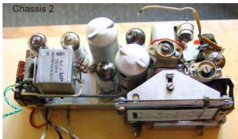
Chassis 2 mit 6 Röhren, inkl. DM70
