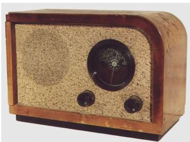
ZEHETNER Phonetta Volkssuper. Mit diesem Gerät wurde der Übergang hin zum Typus des Superhetempfängers vollzogen. Der Preis für dieses Gerät betrug 840,-
