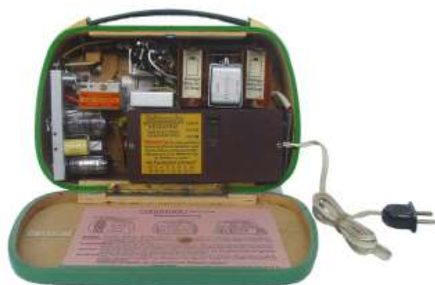
ZEHETNER Frohsinn Piccolo BW 53, Innenansicht mit Netzgerät
