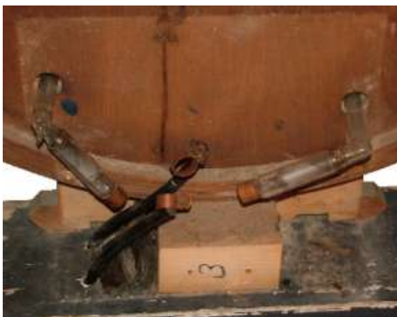
Detailansicht: Elektroden der Neonröhre
