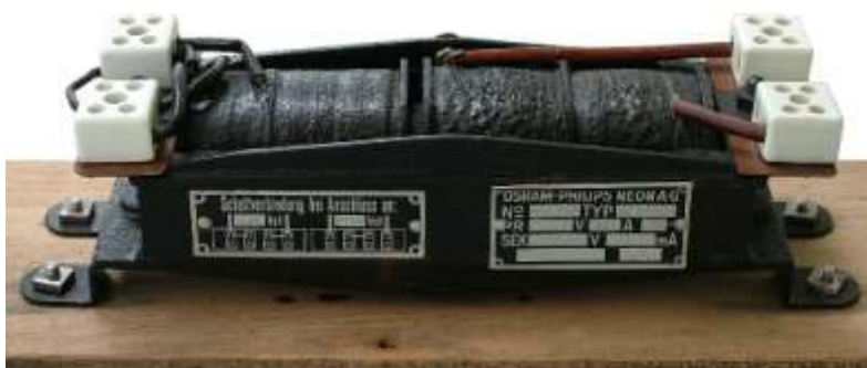
Der geprüfte und restaurierte Streufeldtrafo
