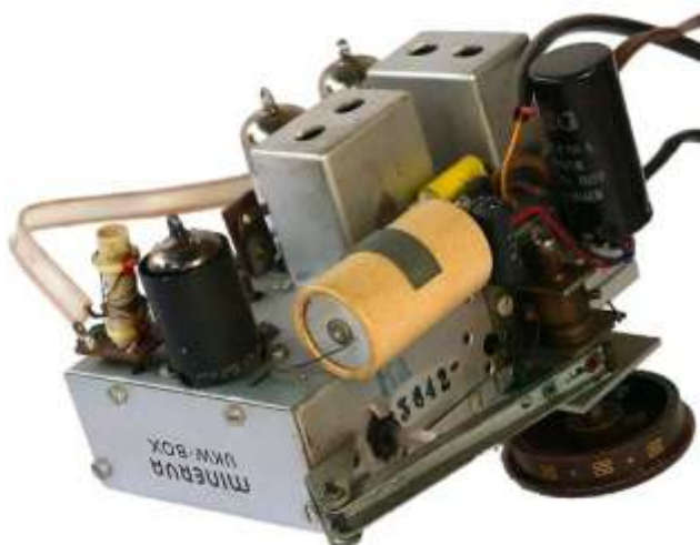
1954: Die Minerva „UKW- BOX“, ein universell verwendbarer Einbausuper
