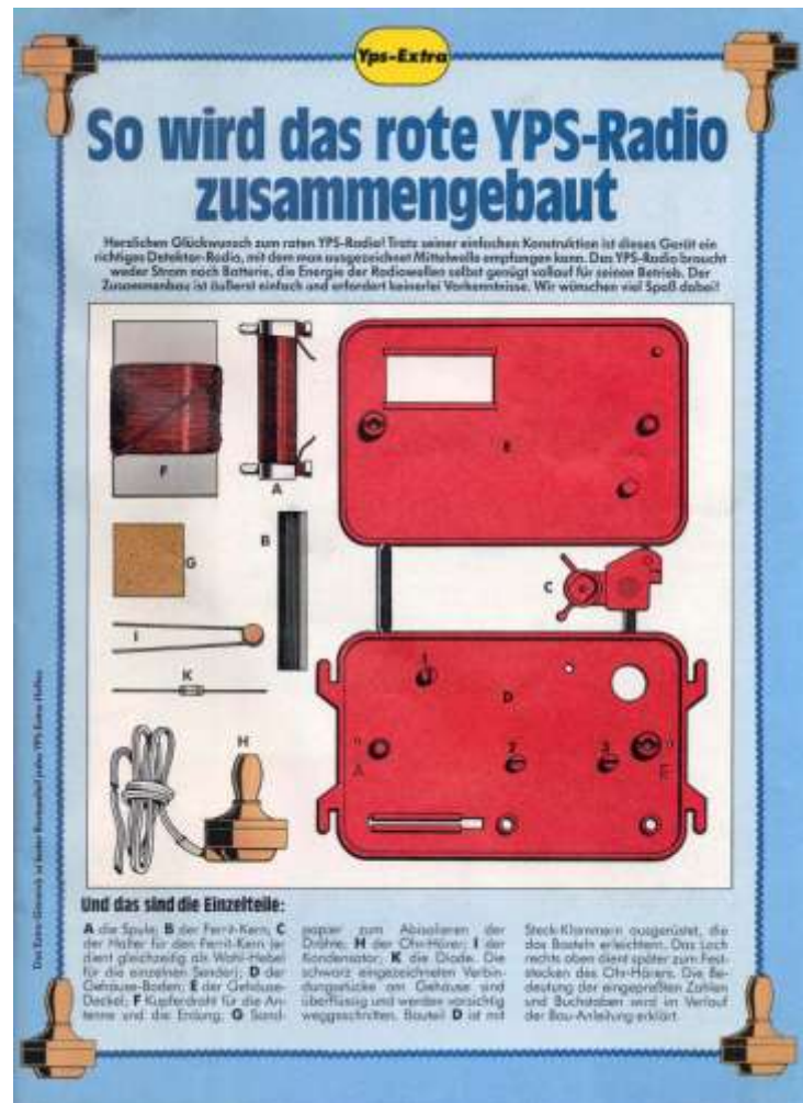
Das rote Yps-Radio, Bauanleitung
