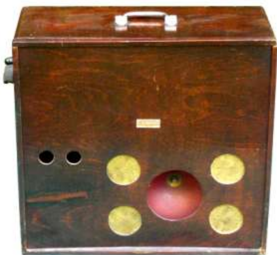
Transportabler Empfänger ERHAPHON Type G Vollnetzempfänger mit 2 Ostar Röhren, A520 und U920 und einem Schild „Musicaphon Bauerlaubnis Telefunken Nr. 1874“ ebenfalls im Geräteinneren.
