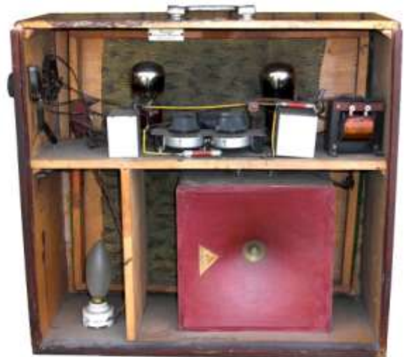
Transportabler Empfänger ERHAPHON Type G Vollnetzempfänger mit 2 Philips Röhren, B438 und B406 und einem Schild „Musicaphon Bauerlaubnis Telefunken Nr. 2469“ im Inneren (!) des Gerätes.
