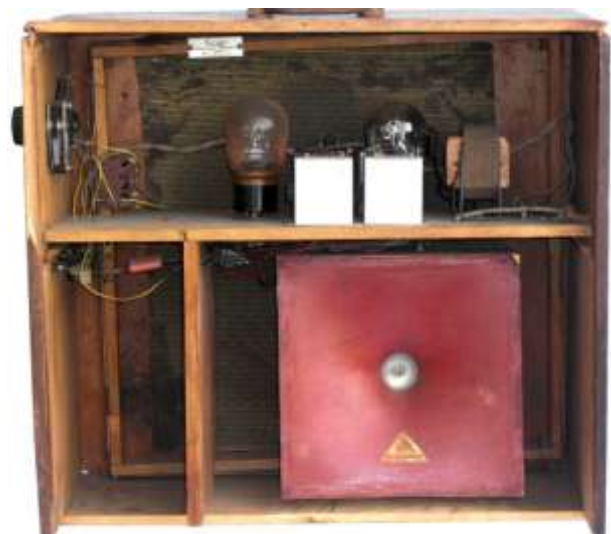
Transportabler Empfänger ERHAPHON Type G Vollnetzempfänger mit 2 Ostar Röhren, A520 und U920 und einem Schild „Musicaphon Bauerlaubnis Telefunken Nr. 1874“ ebenfalls im Geräteinneren.
