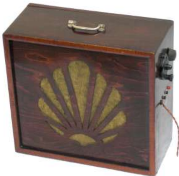
Transportabler Empfänger ERHAPHON Type G Vollnetzempfänger mit 2 Philips Röhren, B438 und B406 und einem Schild „Musicaphon Bauerlaubnis Telefunken Nr. 2469“ im Inneren (!) des Gerätes.
