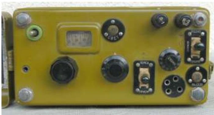
Ihr Frequenzbereich ist der gleiche wie der der RRU, die Sendeleistung und Reichweite sind geringfügig größer. „Büschelantenne“ und Gegengewicht sind ähnlich. Für ortsfesten Aufbau wurde ein Halbwellen-Dipol empfohlen. Das Gerät ist mit 4 Röhren bestückt und arbeitet als zweistufiger Sender mit Heising-Modulator bzw. als Empfänger mit HF-Vorstufe, Pender und NF-Stufe. Dabei werden für HF-Vorstufe und Sendestufe verschiedene Röhren
