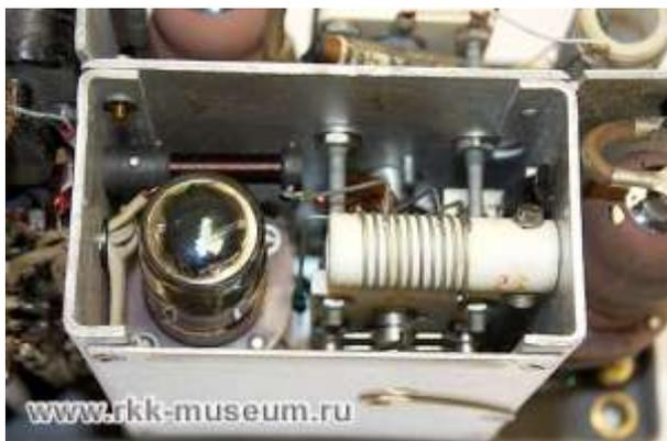
Der grundsätzliche mechanische Aufbau entspricht dem RRU, ist jedoch in allen Punkten solider. Der frequenzbestimmende Oszillator ist in einem geschlossenen Aluminiumgehäuse eingebaut, was die Frequenzstabilität erhöht.
