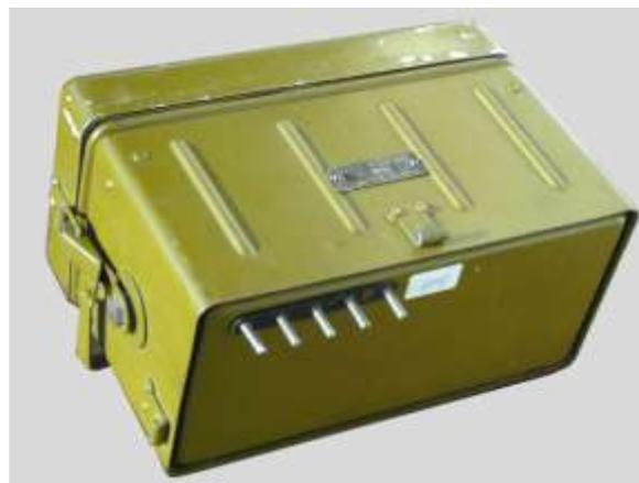
Der zweiteilige Tornister wird am Schulterriemen getragen. Die Stromversorgung übernehmen ein NC-Akkumulator (2,4 V) und zwei Anodenbatterien (100V). Die Betriebsdauer beider Batteriesätze von 20 bzw. 36 Stunden wird für ununterbrochenen Funkbetrieb angegeben.
