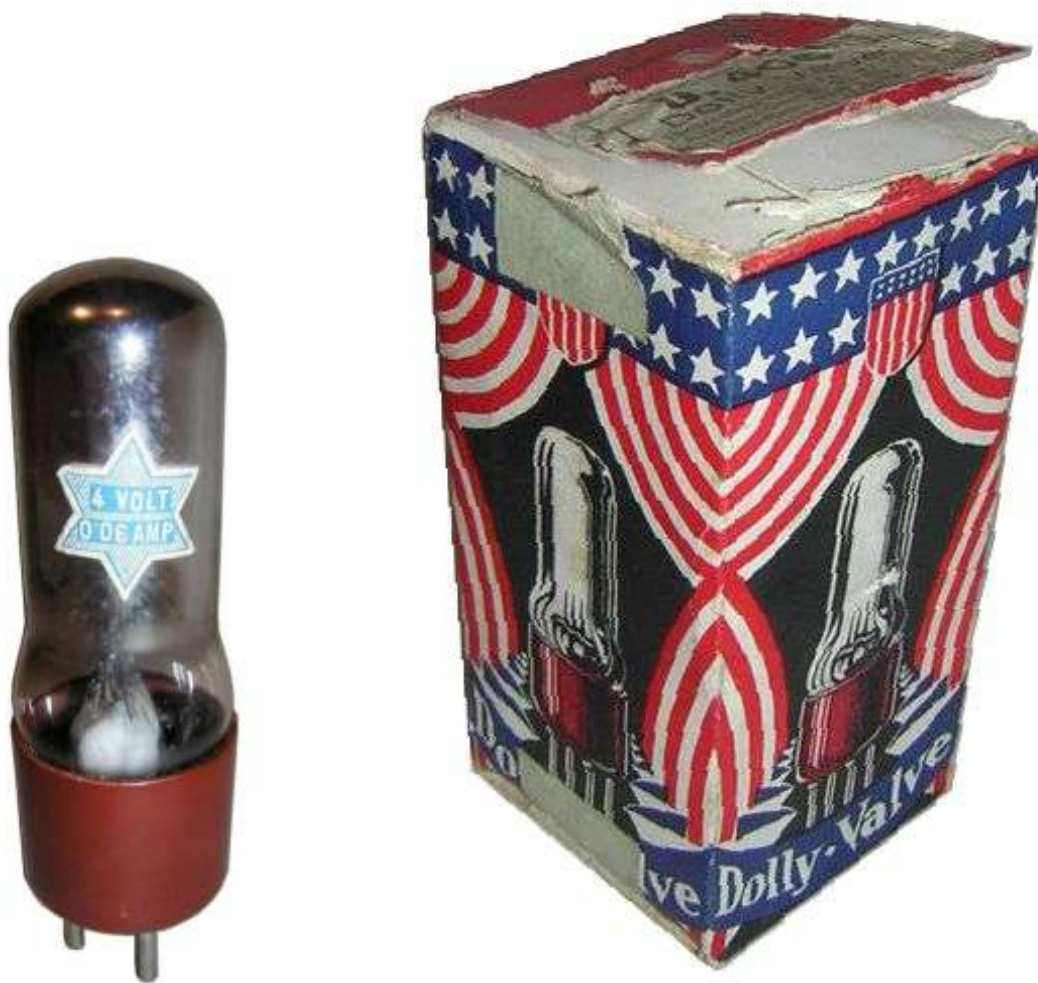
Abbildung 18: Dolly-Röhre U406 und Originalkarton
