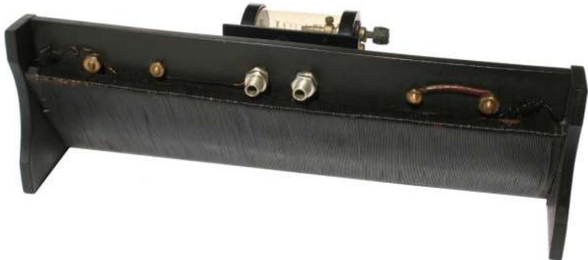
Schiebespulendetektor: Ansicht von unten
