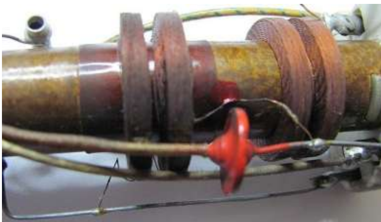
Kurzschluss zwischen Spulendraht und Kondensator behoben
