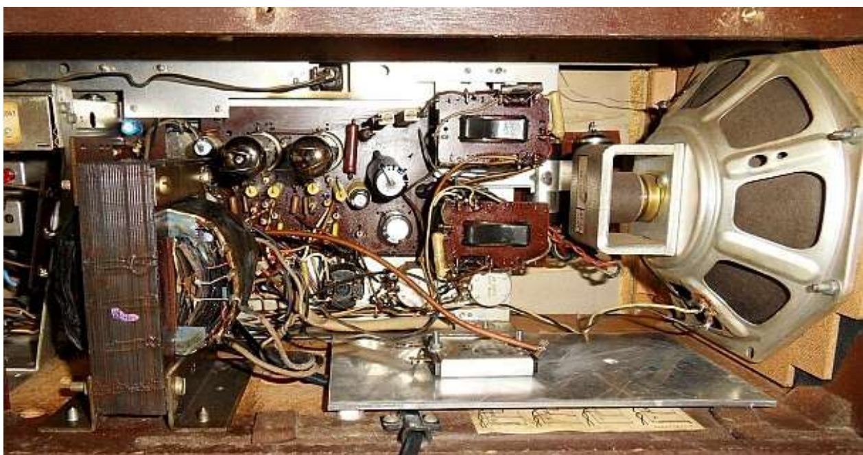
Detailansicht des NF-Teils mit dem linken Lautsprecher, am Boden das eingesetzte Kühlblech für den Gleichrichter
