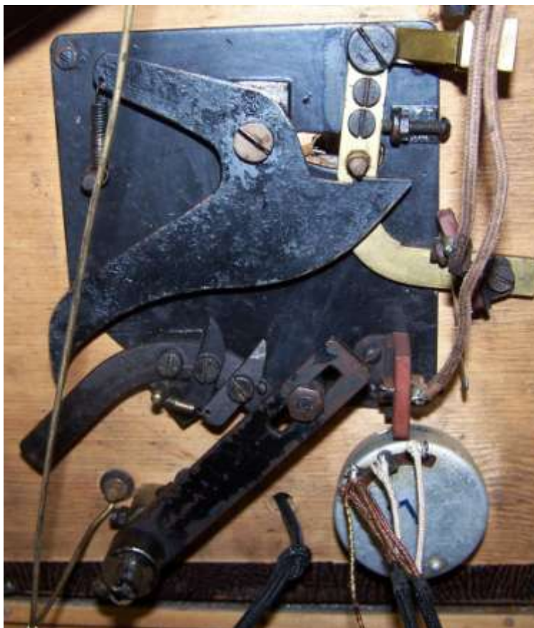
Die Mechanik des Plattenspielers und das Lautstärke-Potentiometer, rechts der Motor und das darauf angebrachte DUAL-Logo
