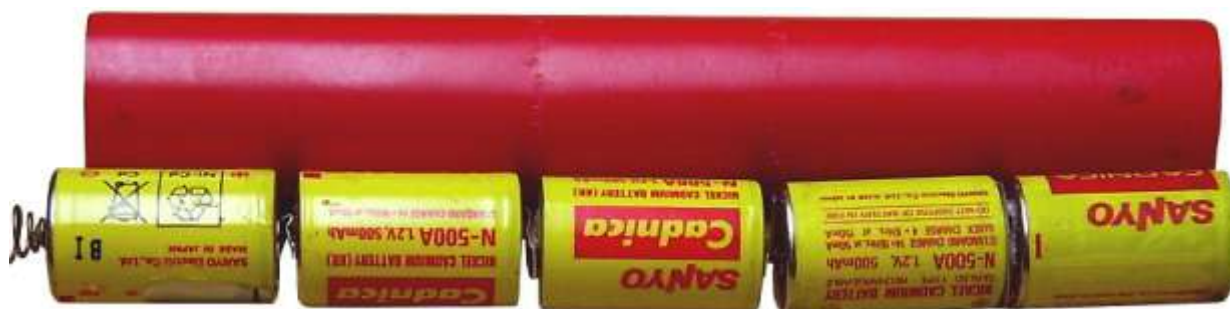
Im Vordergrund die 5 Zellen, dahinter das originale Batterierohr
