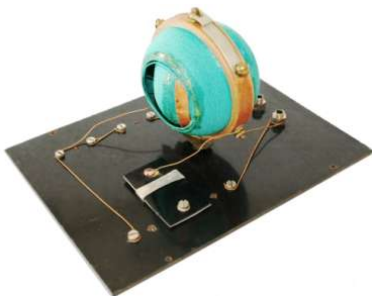
Ein Blick ins Innere auf das Variometer und auf den Kondensator
