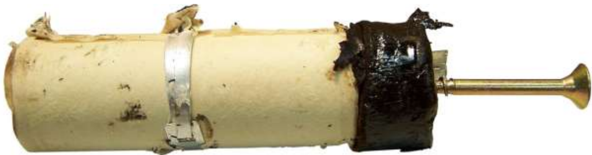
Mit Hilfe der Schraube wird der Wickel aus dem Becher entfernt
