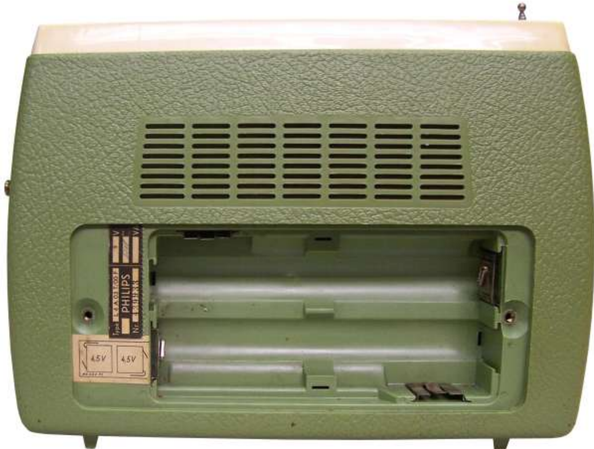
Blick auf die Rückwand mit dem geöffneten Batteriekasten
