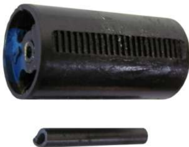
Linkes Bild: Der gebrochene Ferritkern vor der Reparatur
