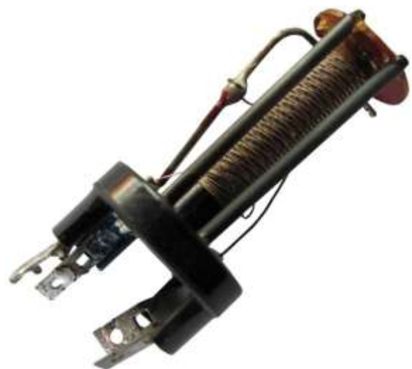
Rechtes Bild: Die Abstimmspule bei abgenommener Haube
