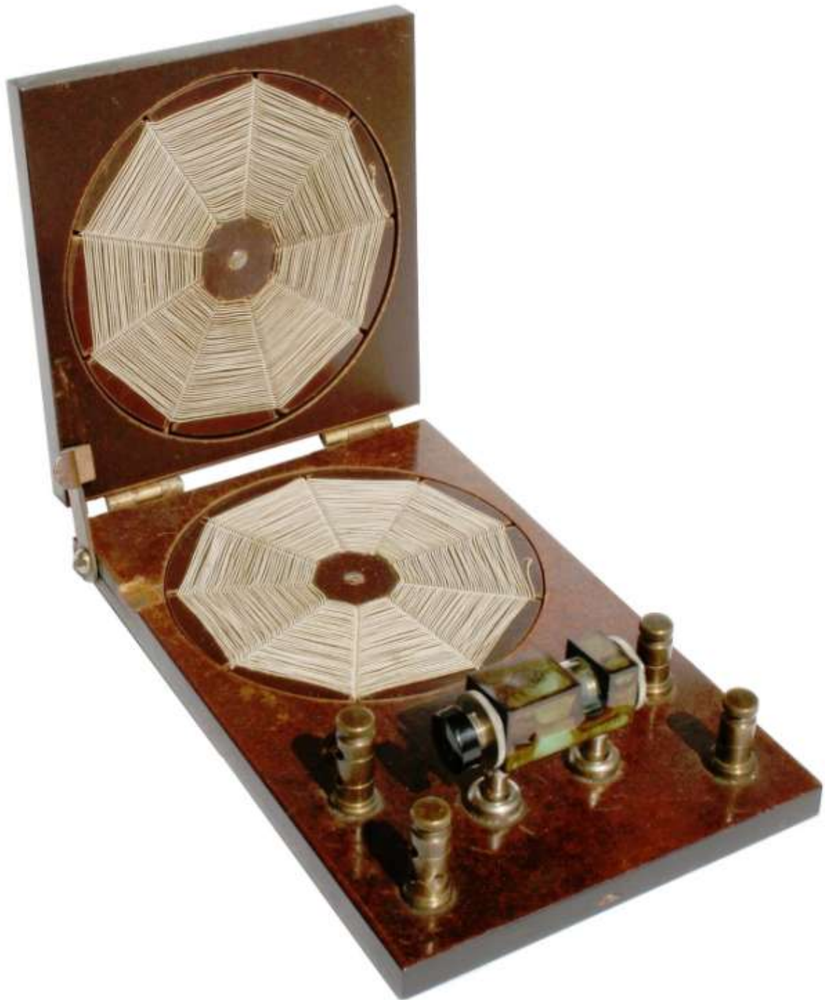
Der Eigenbaudetektor in geöffnetem Zustand
