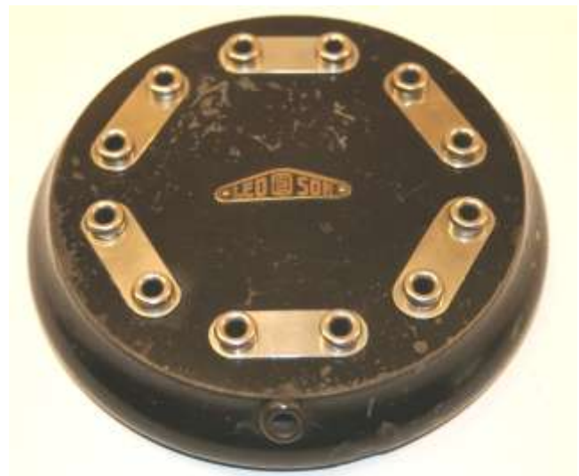
Links: Zusatzverteiler von KAPSCH, rechts vom Hersteller LEOSON, beide in Holzdosens eingebaut
