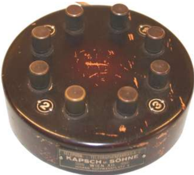
Links: Zusatzverteiler von KAPSCH, rechts vom Hersteller LEOSON, beide in Holzdosens eingebaut
