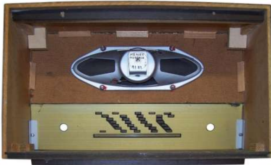
Innenansicht des Gehäuses. Lediglich die Längsachse des Lautsprechers sorgt für eine befriedigende Basswiedergabe
