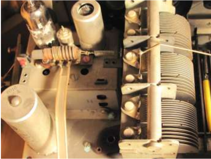
Oben: Sechsfach-Drehko und induktiv abstimmbarer UKW-Eingangskreis
