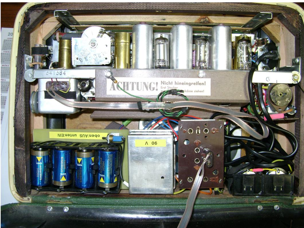
Bild 2: Die Elektronische Anodenbatterie im einem Bajazzo 55
