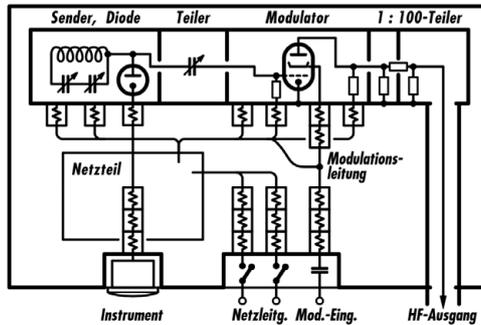
Bild 2. Schirmung der Senderstufen und Verblockung der Hilfsspannungen.
