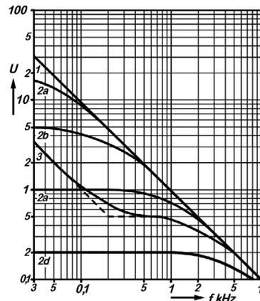
Bild 1. Frequenzgänge von Kristalltonabnehmern bei konstanter Geschwindigkeitsamplitude. I unentzerrt, 2 a bis d mit ohmscher Belastung, 3 in Schaltung Bild 3 entzerrt.
