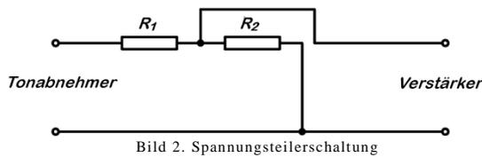
Bild 2. Spannungsteilerschaltung
