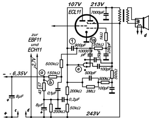
Bild 2. Niederfrequenzstufen eines Kleinsupers mit ECL11.
