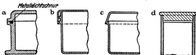
Trennfugen bei Schirmungen höchsten Schirmgrades. a Gußgehäuse mit Kontakt durch Metalldichtschnur, b Blechgehäuse mit Doppelkontakt, c Blechgehäuse mit Konuskontakt, d Gehäuse mit Kontakt durch Passung.
