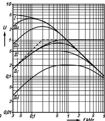
Bild 2. Frequenzgänge von Schallplatten - Wiedergabegeräten bei konstanter Spannung am Tonschreiber. I Kristallabnehmer unentzerrt, II a bis d Kristallabnehmer mit ohmscher Belastung, III Kristallabnehmer entzerrt, IV magnetischer Abnehmer unentzerrt.
