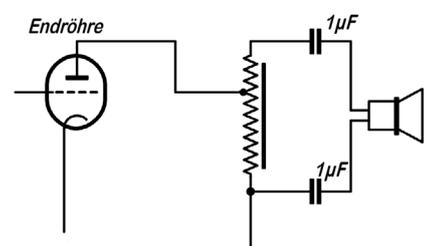
Bild 5. Anschluß eines Kristall-Lautsprechers über LC-Kopplung.
