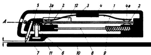
Bild 2. Schnitt durch den Kristall-Tonabnehmer.
