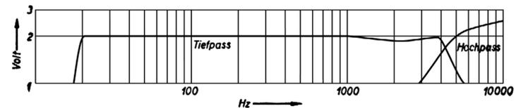
Bild 7. Frequenzverlauf von Tiefpaß und Hochpaß.
