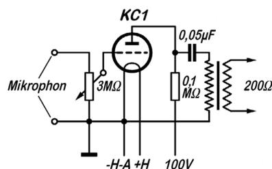
Bild 3. Einstufiger Mikrofon-Vorverstärker für Kristall-Membran-Mikrophon
