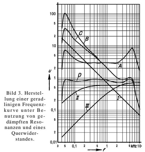
Bild 3. Herstellung einer geradlinigen Frequenzkurve unter Benutzung von gedämpften Resonanzen und eines Querwiderstandes.
