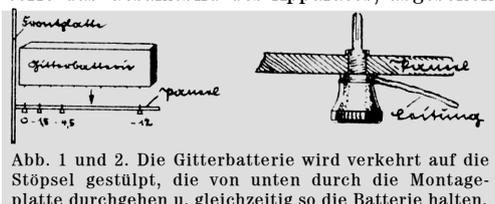
davon, daß es leicht vorkommen kann, daß ein Stecker versehentlich einmal mit dem Draht herausgezogen wird und die Röhre ohne Vorspannung arbeitet. Eine solide Befestigung der Batterie macht durch Platzmangel oft Schwierigkeiten.
