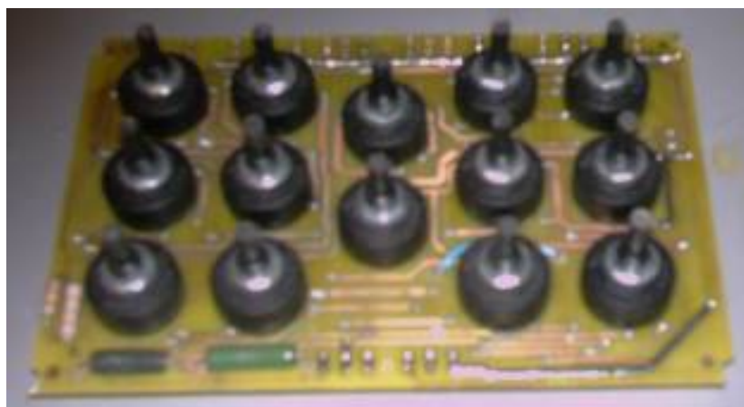
Fig.23 : Bloc de combinaisons – Les commutateurs et résistances de puissance.
