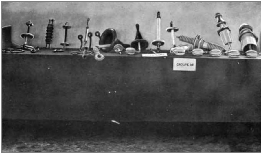
Abb. 14. Isolatoren und Durchführungen
