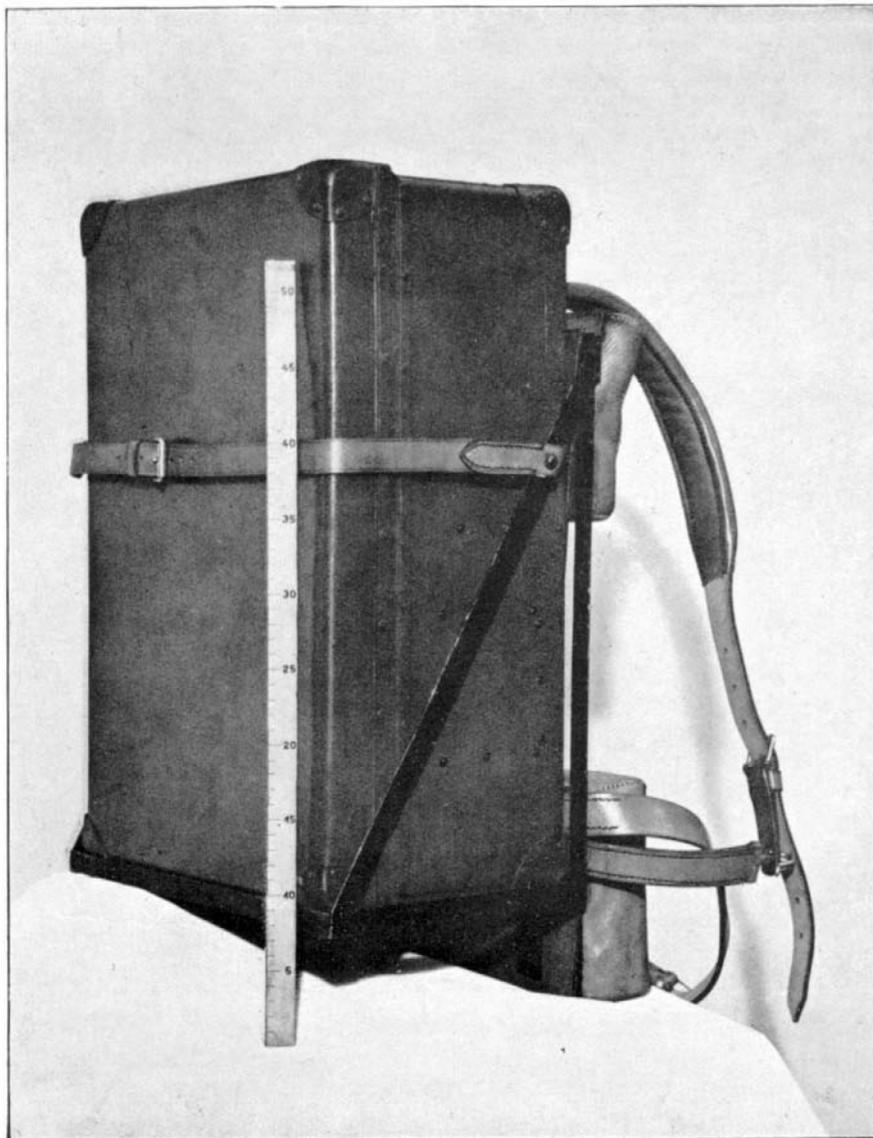
Abb. 41. Sender-Empfänger, transportfähig verpackt.
