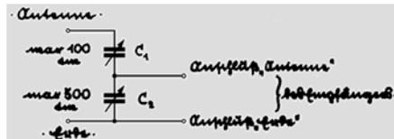
Abb. 2. Hat man eine große Antenne zur Verfügung, dann empfiehlt sich eine Eingangsschaltung wie diese.
