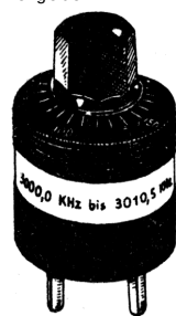
Bild 4 Varioquarz in seinem Halter mit Drehknopf.
