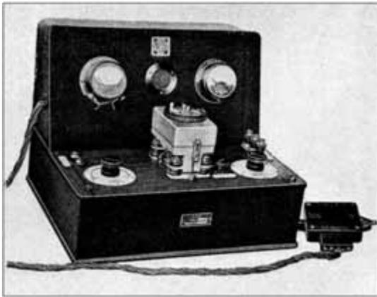
Bild 38. Einröhren-Gleichrichter mit Relais
