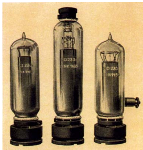
Bild 99. Senderöhren mit Sparfäden (Thoriumfäden) zur Verringerung des Heizwattbedarfs, für bis zu etwa 75 Watt Hochfrequenzleistung bei 1000 Volt Anodenspannung. Rechts: Zweigitterröhre für eine besondere Modulationsmethode.
