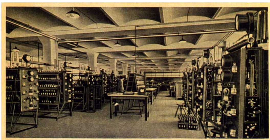
Bild 102. Die Serienfabrikation von Telefunken-Rundfunkempfangsröhren im Osram-Werk A, Sickingenstraße. Brennstände mit Rahmen für das Einbrennen der Röhren.
