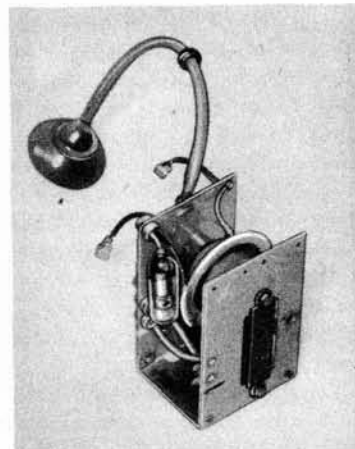
Unten: Bild 148b. Zeilenankoppelspule und Hochspannungstrafo, verwendet in Schaltung Bild 147b
