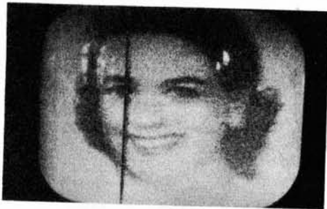
Bild 152. Bildfehler a) „Barkhausen-Schwingung“: senkrechte, scharf abgegrenzte schwarze Striche auf der linken Bildseite.
