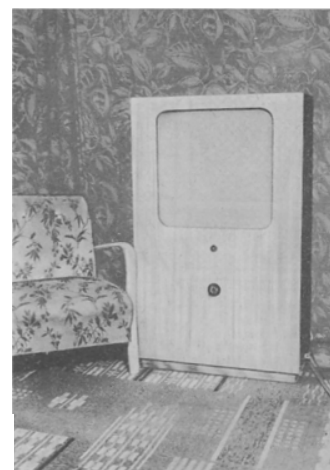
Bild 32 (rechts). Lautsprecherschrank mit acht Systemen auf einer geknickten Schallwand
