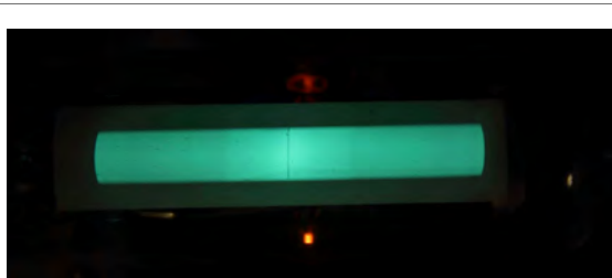
Abbildung 1: Schirmbild mit 120 Volt Anodenspannung
