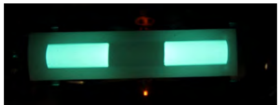
Abbildung 2: Schirmbild mit 240 Volt Anodenspannung
