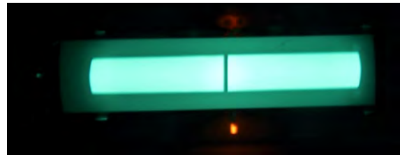
Abbildung 7: Helligkeit bei 75% Tastgrad
