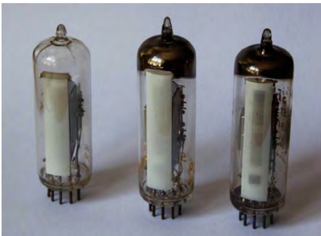
Abbildung 6: von links: EM84, EMM803 (beide neu), daneben eine EMM803 mit deutlichen Einbrennspuren
