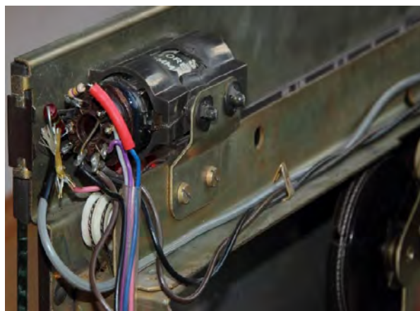
Abbildung 3: Verdrahtung der EMM803
