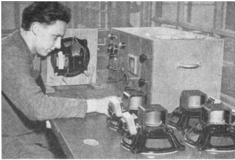
Bild 1: Lautsprecherprüfung mit dem Tongenerator
