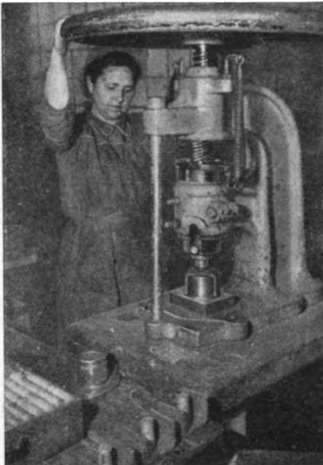
Bild 3: Eindringen der Magnetkerne auf dem Balancier
