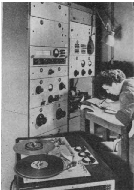
Bild 10: Endprüfung der Tonbänder am automatischen Prüfstand. An diesem Meßplatz, der einen Tonfrequenzgenerator, Aufsprech- und Wiedergabeverstärker sowie verschiedene Dämpfungsglieder und Filter enthält, werden u. a. die Empfindlichkeit, der Frequenzgang, die Ruhedynamik, der Gleichfeldrauschspannungsabstand und die Klirrdämpfung gemessen
