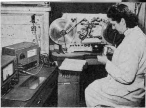
Bild 8: Meßplatz für die Prüfung von Magnettonfilm in der Filmfabrik Agfa Wolfen
