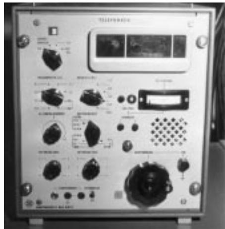
**Bild 12:** Funkempfänger E 863 Kw/2 (Bundeswehr-Version mit deutscher Beschriftung).
