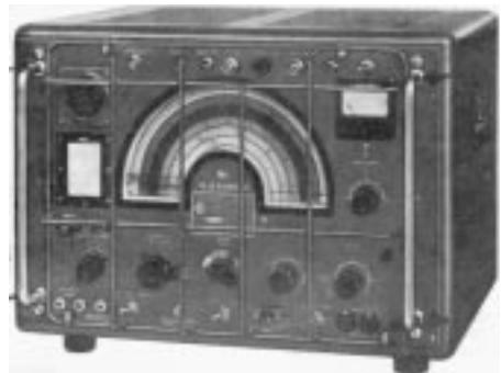
**Bild 2:** HF-Empfänger E 127 Kw/5 (militarisierte Version).
