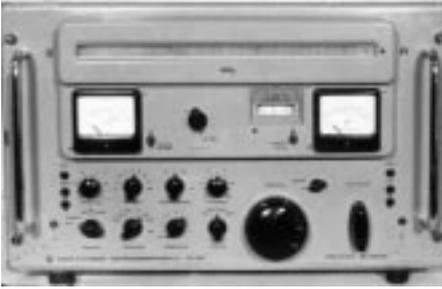
**Bild 3:** HF-FmAufkl-Empfänger EK 07/D2.
