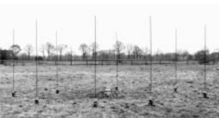
**Bild 11: Aktive Adcock-Antenne mit etwa 1 m hohen Stabantennen. (Werkfoto Plath)**
