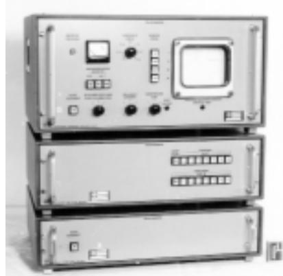
**Bild 1: VHF-Panoramaempfangsanlage AWN 862/1 von Telefunken. Oben der Panoramaempfänger 20-180 MHz, darunter das Einblendgerät EBG 862, unten das Netzgerät zum Anschluss an 220 V.**
