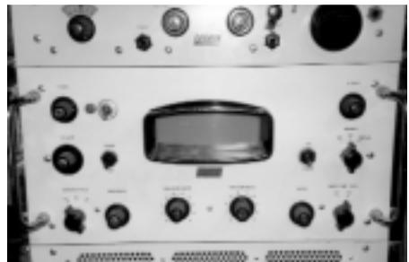
**Bild 4: Panoramazusatz RA-66 zum HF-Empfänger RA 17 von Racal.**
