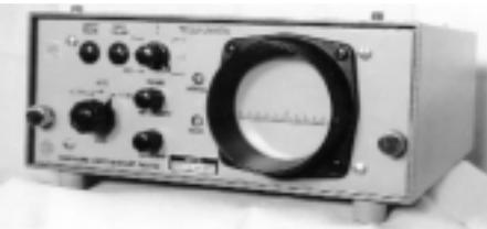
**Bild 7: Panoramaanzeigezusatz PaG 148 von Telefunken (ZF-Eingang 10,7 MHz). Der PaG 724/525 für die Telefunken-ZF von 525 kHz sah ähnlich aus.**
