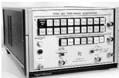
**Bild 9: Zeitmarkengenerator 184 der Firma Tektronix.**
