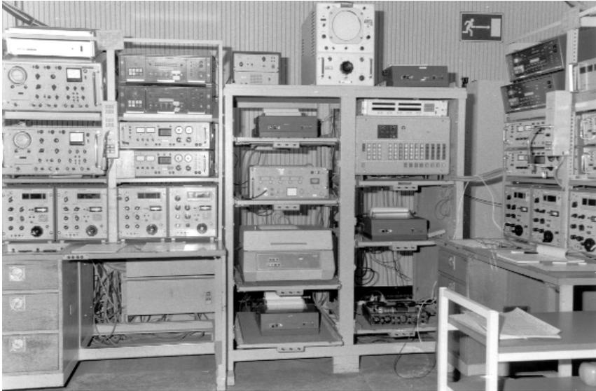
**Bild 12: Ortsfest eingesetzter Arbeitsplatz zur Schreibfunkerfassung mit Empfängern E 863 (etwa 1980). Im Gestell rechts ein standardisiertes Schaltfeld des Arbeitsplatzes, ganz unten ein Tonschreiber M 36. Die übrigen Geräte können anhand der anderen Fotos dieses Beitrags identifiziert werden.**
