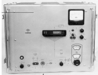
**Bild 10: Frequenzanalysator FA 2 der Firma Schomandl.**
