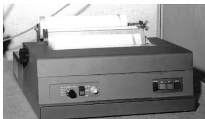
**Bild 6: Empfangsdrucker AH-11-y der Firma Transtel.**
