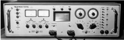
**Bild 2: Fernschreib-Tastgerät TG 44 E der Firma Pfitzner.**
