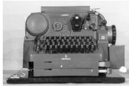
**Bild 4: Fernschreibempfänger Typ 68d spezial der Firma Siemens.**
