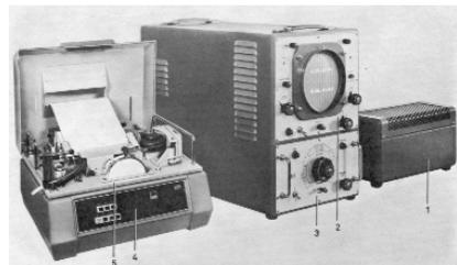
**Bild 11: Registrier- und Analysiergerät Zeit, Modell ES 219y der Firma Hell (v.l.: Registriergerät BS 134, Oszilloskop ES 216 mit Oszillator ES 217 und Stromversorgung).**
