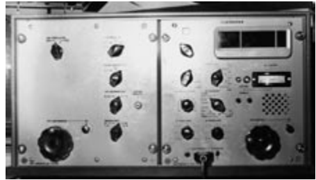
Bild 4: Fernmeldeaufklärungsempfänger EUK 724. Rechts der HF-Empfänger E 724 Kw/2 (1-20 MHz), links der VHF-Vorsatz UK 724/80.
