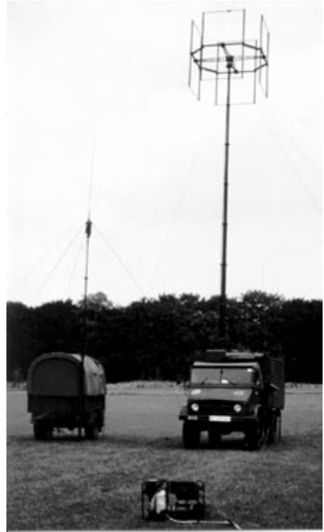
Bild 5: Peiltrupp 1-80 MHz mit der VHF/HF-Peilantenne A 638/80BwH auf dem pneumatischen Mast SCAM 30 (Serienversion). Links der Transportanhänger für Antenne, Stromerzeuger und ein SEM-25 (hier mit Antenne Standbetrieb auf Kurbelmast 6 m).
