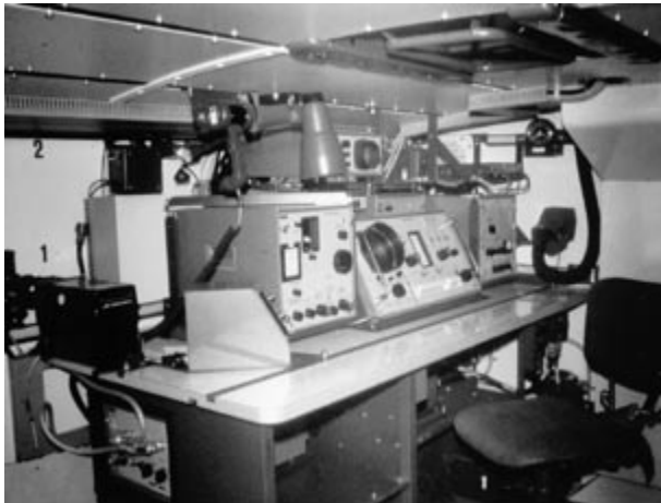
Bild 6: Peilarbeitsplatz des Peiltrupps HF/VHF (letzte Serienversion). Auf dem Tisch der Peilempfänger mit VHF-Vorsatz und Einseitenbandzusatz, oben das Panoramaanzeigergerät, links unter dem Tisch der Frequenzzähler.
