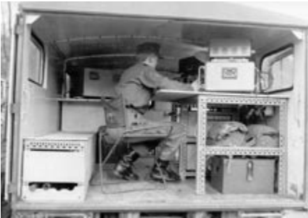
Bild 1: Behelfsmäßiger Truppeneinbau als „Vorbild“. Empfänger E 148 mit darauf montierten Magnetplattengeräten TS-3, rechts unten ein HF-Antennenbaukasten.
