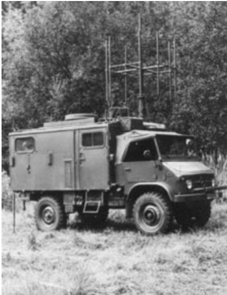
Bild 3: Erster Prototyp des FmAufkl-GerSatzes 1-80 MHz mit 8-fach-Adcock auf eingefahrenem Antennenmast. Auf dem Fahrzeugdach der HF-Ferritkruzrahmen PR 638.
